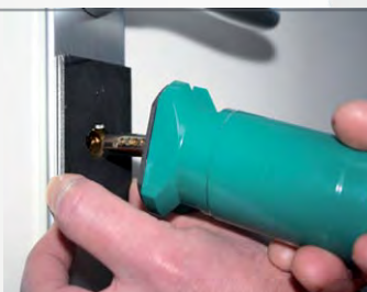
Utilisation de l'extracteur avec la contre-plaque sur cylindre européen
