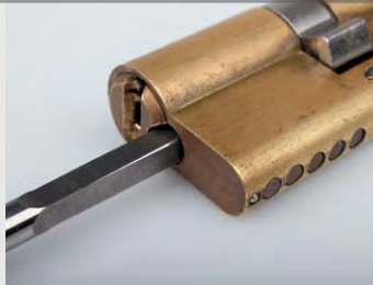
Fraise carrée sur cylindre avec insert anti perçage en façade
