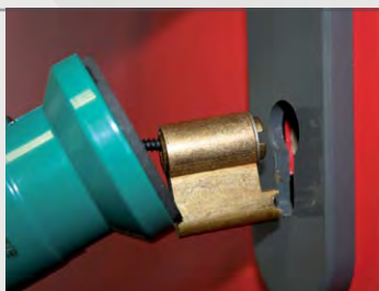
Utilisation de l'extracteur sur cylindre européen
